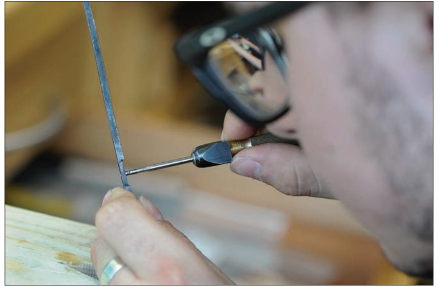
Le taraudage du balancier demande une grande précision.
